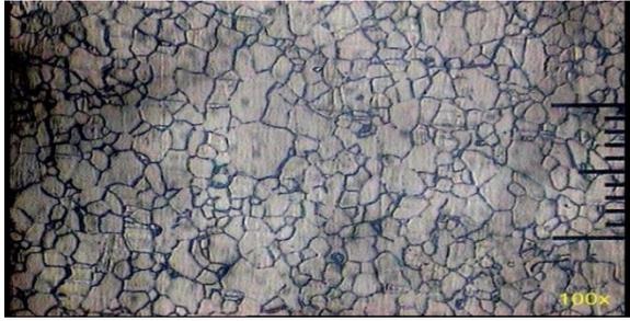
**Gambar 11.** Struktur mikro *row material*
