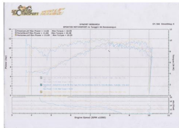
Gambar 4. Perbandingan Udara-Bahan Bakar Hasil Uji Dynotest
