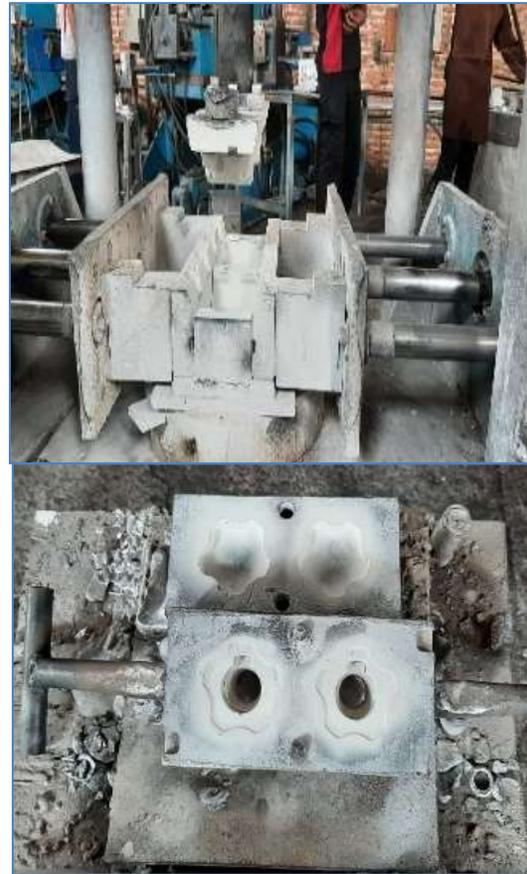
Gambar 5. Cetakan logam.
