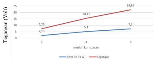
Gambar 12. Grafik pengukuran output tegangan listrik (voltase) pada generator horizontal blade.
