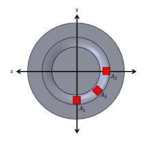
Gambar 6. Posisi - Posisi Kritikal pada Cekungan (Fillet) Pemutar
