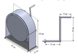
Gambar 5. Dimensi Keseluruhan Alat.
