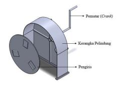
Gambar 3. Komponen - Komponen dalam Mekanisme Pengiris
