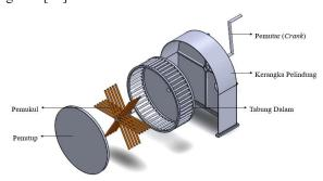
**Gambar 2**. Komponen - Komponen dalam Mekanisme Pengupas.
