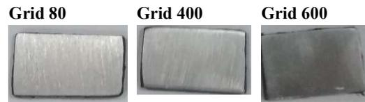
Gambar 5. Contoh spesimen setelah pengujian korosi.
