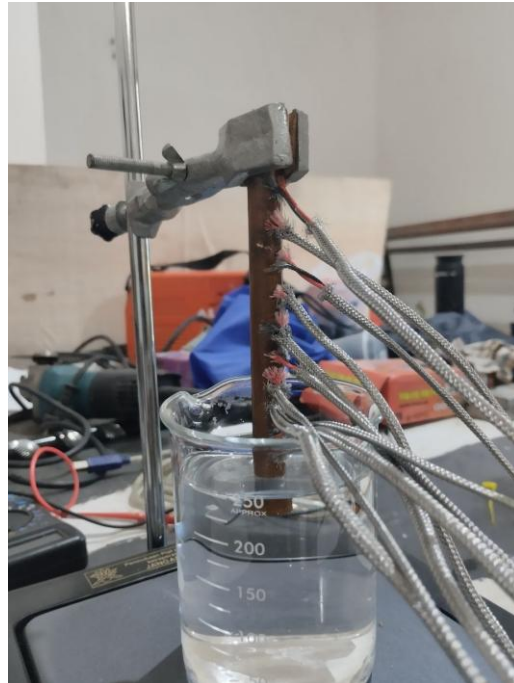
Gambar 11. Posisi termokopel T1 berada pada bagian bawah beeurutan hingga T10 pada posisi paling atas
