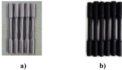
Gambar 4. a) Sebelum pelapisan, b) sesudah pelapisan
