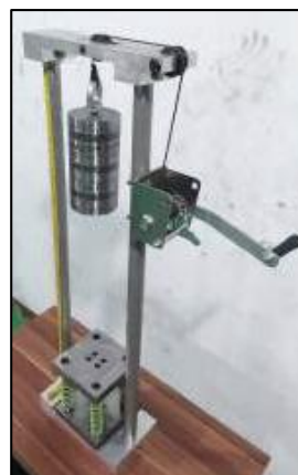
Gambar 8. Drop Hammer yang dibuat saat penelitian
