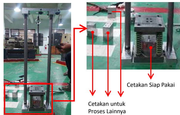
Gambar 11. Cetakan pembentukan Paku Ladam Kuda
