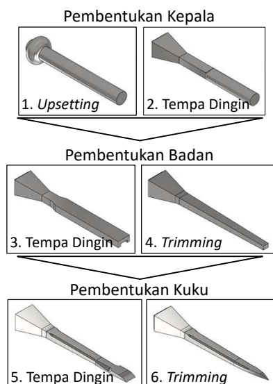
Gambar 6. Tahapan proses pembentukan paku ladam kuda proses tempa dingin
