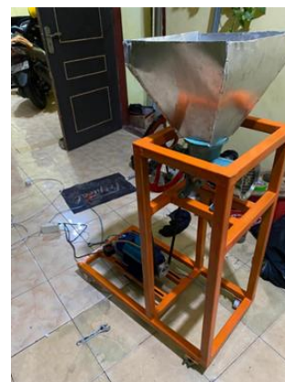
Gambar 10. Alat Pencetak Pelet Yang Sudah Dirakit
